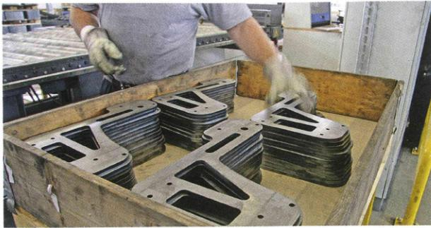
Nach dem Walzenrichten sind die Platinen perfekt eben und spannungsfrei – ideal für die weitere Bearbeitung.
