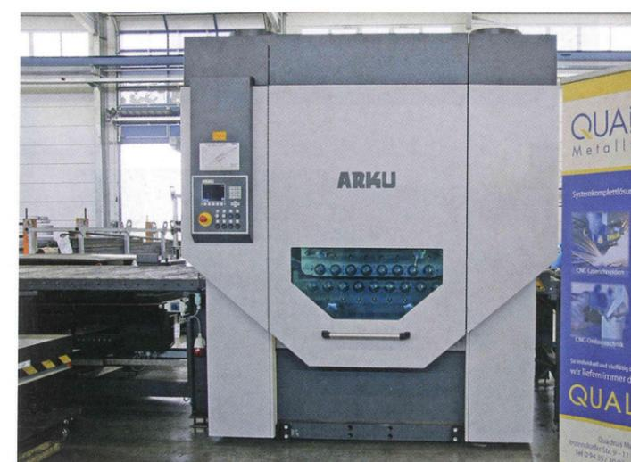
Die Erfahrung von Quadrus ist eindeutig: „Im Prinzip sollte jeder Blechbearbeiter eine Teilerichtmaschine haben, denn dadurch wird die Weiterverarbeitung wesentlich einfacher.“
