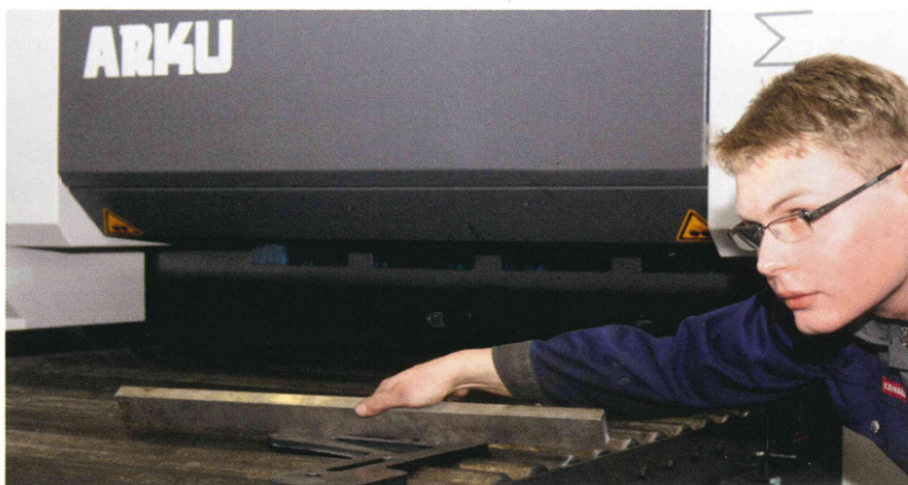
Verformtes Teil nach dem Laserschneiden.
