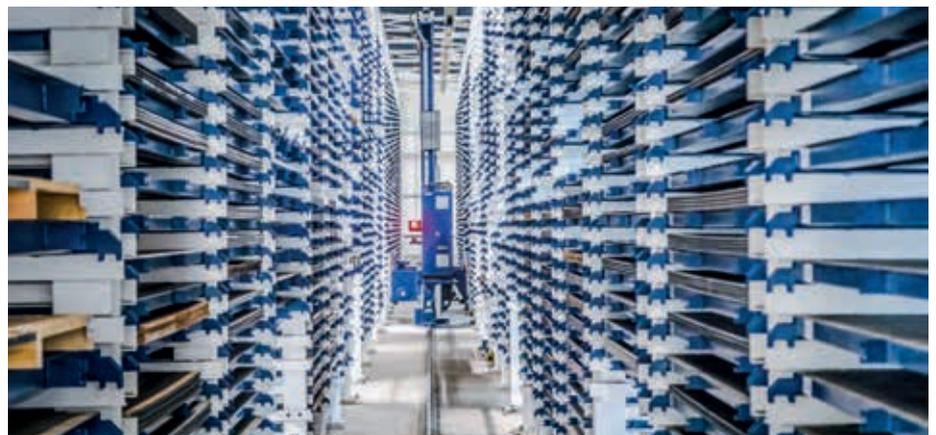
*Das vollautomatische Palettenlager war ein großer Schritt nach vorn bei der Prozessautomatisierung.*
