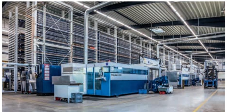
*Um das Palettenlager herum sind die Laser-Maschinen sowie die Stanz-Nibbel-Anlage gruppiert, die automatisch vom Regal versorgt werden.*
